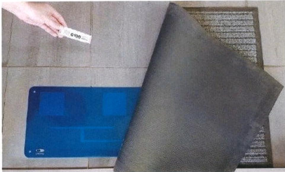
*Une antenne est glissée sous les paillasons/tapis/lino des sorties stratégiques de l'établissement. Ensuite, chaque résident fragile est équipé d'étiquettes à coller dans ses chaussons/chaussures. Le passage du résident sur l'antenne déclenche une alerte qui est renvoyée directement sur les DECT (téléphonie interne) du personnel soignant pour permettre aux équipes d'intervenir rapidement.*
